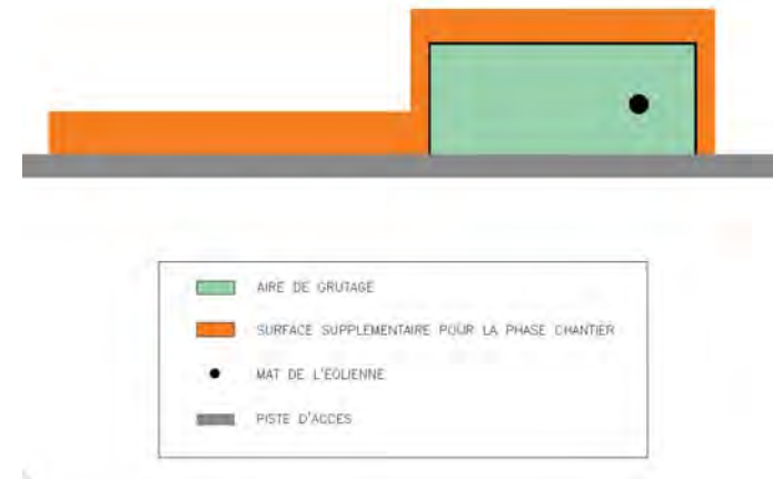
Figure 18 : Schéma de principe d'une plateforme de montage
